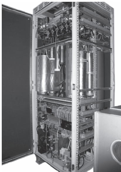
Рис. 3. Комплекс ARIX для мониторинга изотопов ксенона в приземном слое воздуха
