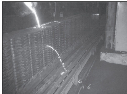
Рис. 1. Разрушение заливочной формы поршневых колец при отклонении положения ковша сверх допустимого уровня
